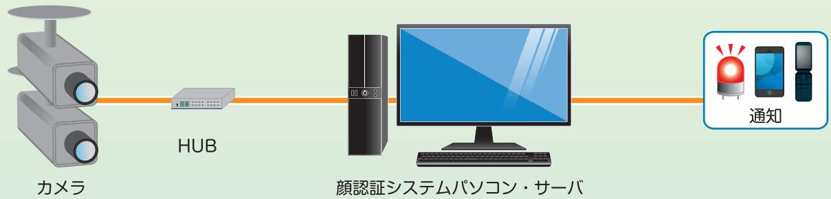
顔認証専用のサーバ・ワークステーションで構成 多数のカメラをサーバ・ワークステーションで処理を行う
